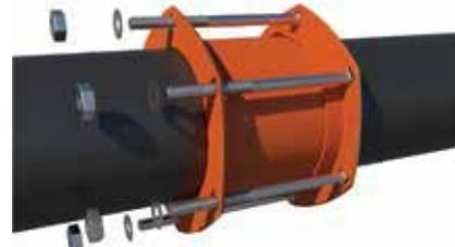
6. Insertar los tornillos, ajustar las tuercas manualmente hasta tocar los flanges.
