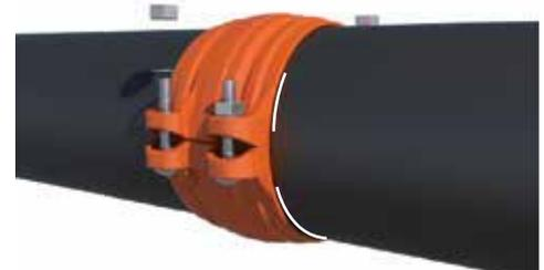
7. **APRIETE LAS TUERCAS:** Apriete de manera uniforme alternando ambos lados hasta obtener contacto metal con metal.
