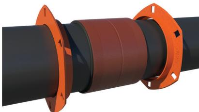
4. Aproximar el otro extremo de la cañería, hasta conseguir que entre extremos se establezca una separación de aproximadamente 13 mm. Esta separación va a permitir la absorción de la dilatación de la línea.
